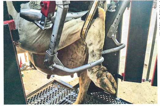
Mechanische und höhenverstellbare Heckklappe mit Sicherheitsbügel, der eine sichere und tierschonende Fixierung der Hinterfüße sowie eine optimale Arbeitshöhe bietet.
